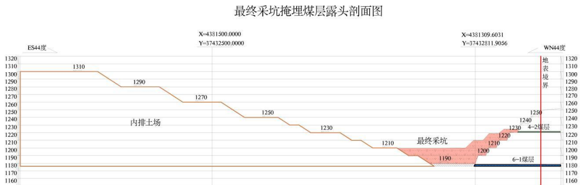
图 5-6 最终采坑回填示意图
