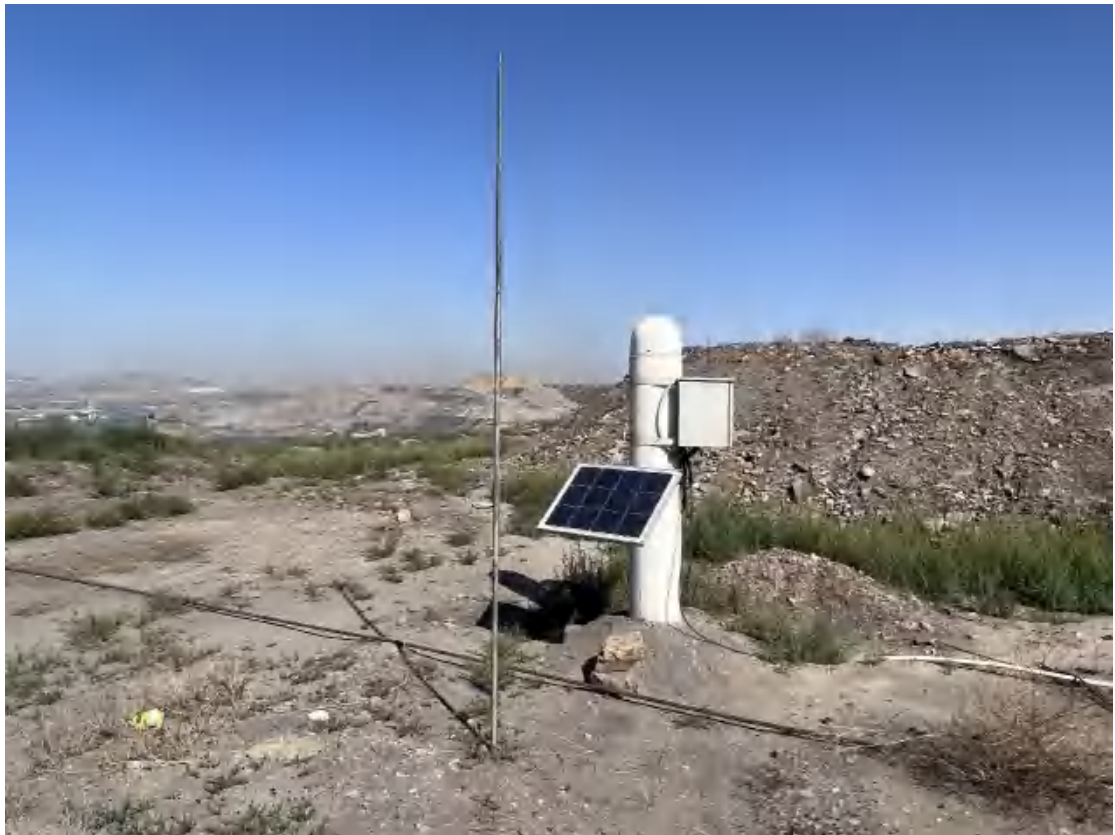
照片 2-8 东辰煤矿边坡地质灾害监测点
