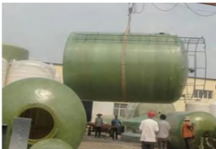
照片*-* 玻璃钢蓄水池
