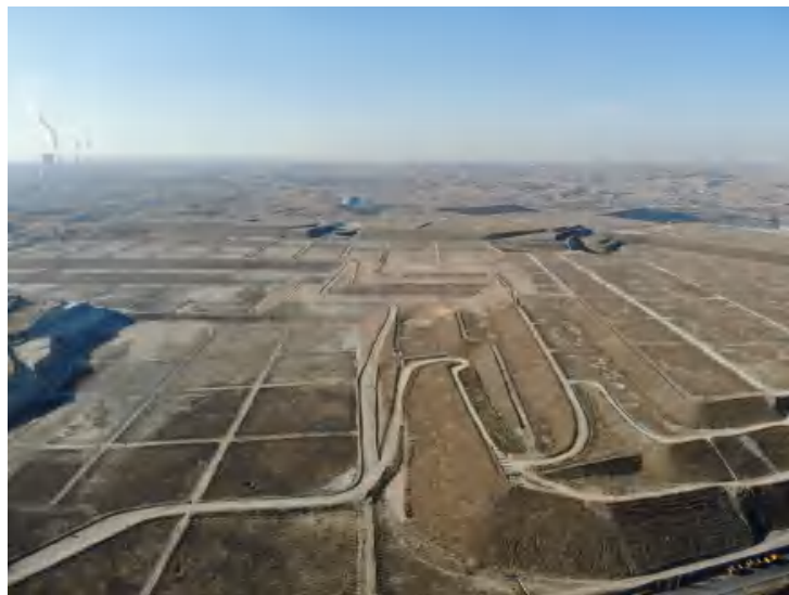
照片 1-2 已治理内排土场
