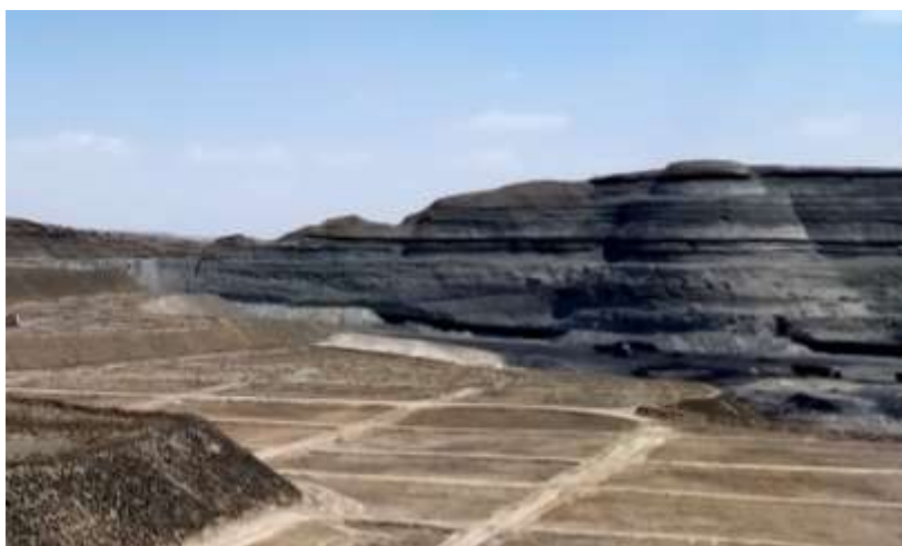
照片 3-1 露天采坑边帮干净、无浮石
