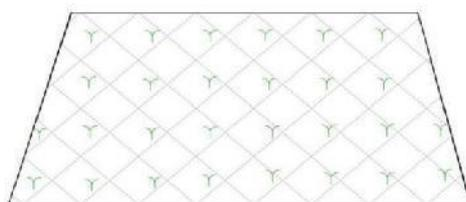
图 5.3-1 边坡设置沙障和人工种草示意图
