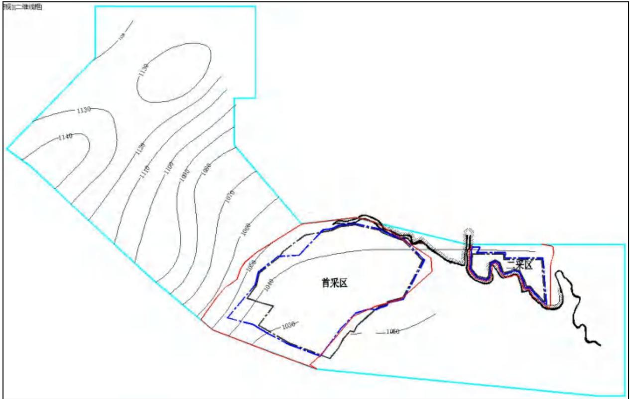
图\*-\* \*号煤层顶板等值线分布图
